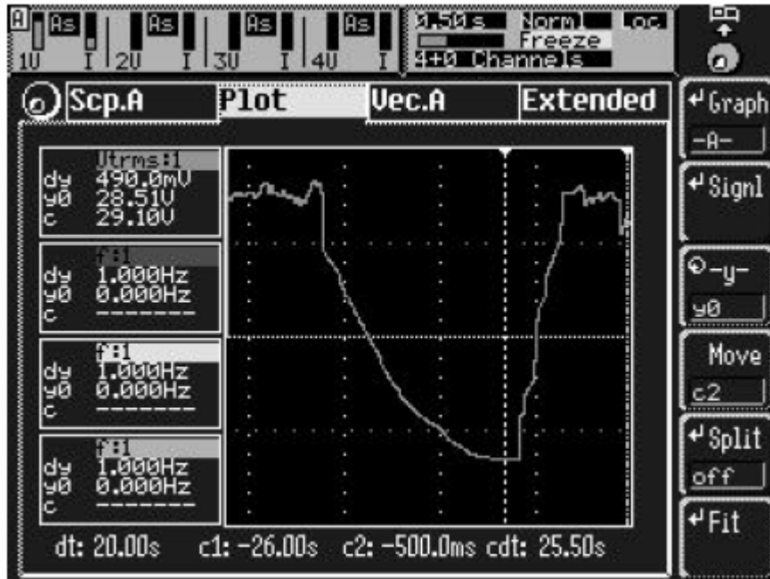
Figura 4. La caída de tensión en el distribuidor de corriente continua registrado con un LMG450.
