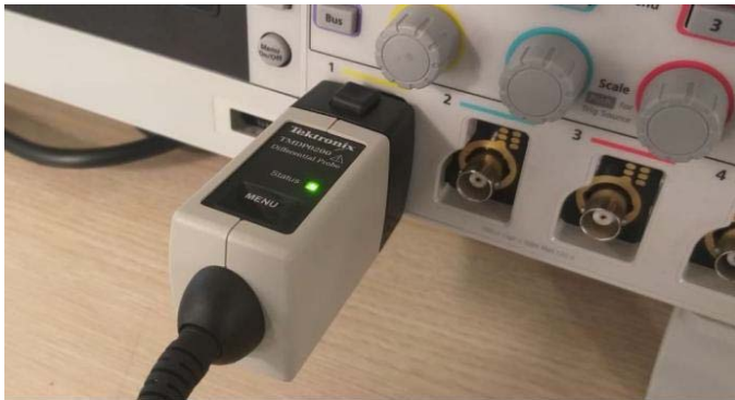
Las sondas TekVPI comunican los ajustes de escala, los rangos y el estado al TBS2000B.
