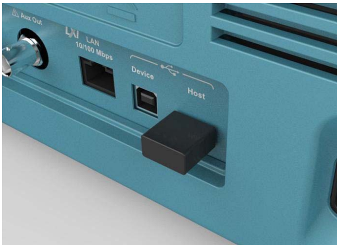
Los adaptadores Wi-Fi se configuran a través de menús de configuración integrados y soportan sin problemas las comunicaciones inalámbricas
