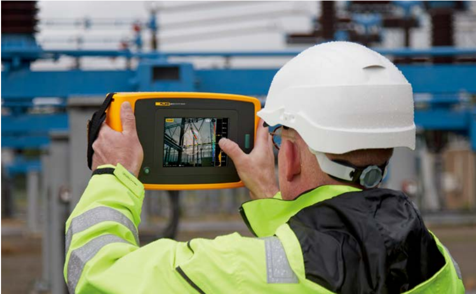
Imagen tomada de la cámara acústica de precisión ii910, que detecta descarga parcial en una aplicación de alta tensión.
