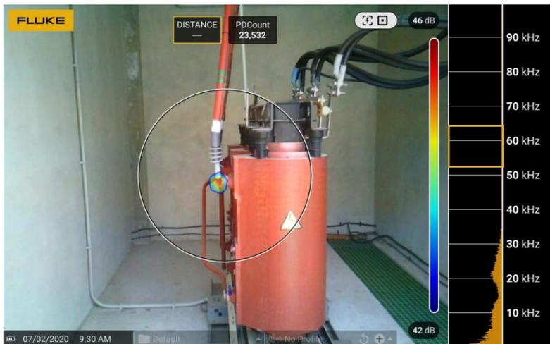
Cuando el componente eléctrico aún está en buenas condiciones el número de pulsos de la descarga parcial será bajo. Cuando el aislamiento del componente eléctrico esté degradado o la superficie esté contaminada el número de pulsos aumentará. Pero cuando el equipo esté cerca del fallo debido a la degradación del aislamiento el número real de pulsos de la descarga parcial puede incluso bajar.
