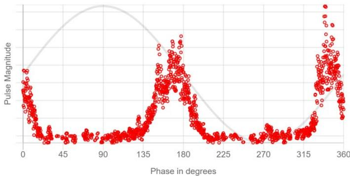
El reconocimiento del tipo de descarga parcial se puede realizar mediante algoritmos avanzados. Gracias a estos algoritmos la ii910 permite clasificar las descargas parciales detectadas en 4 tipos:
