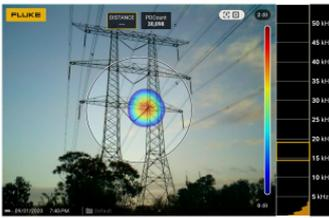
En el ejemplo propuesto (imagen superior) correspondiente a un informe generado automáticamente por la cámara Fluke ii910 vemos como, para la descarga parcial detectada, hay una probabilidad del 100% de que se trate de una descarga externa tipo Corona o Arco Eléctrico.
